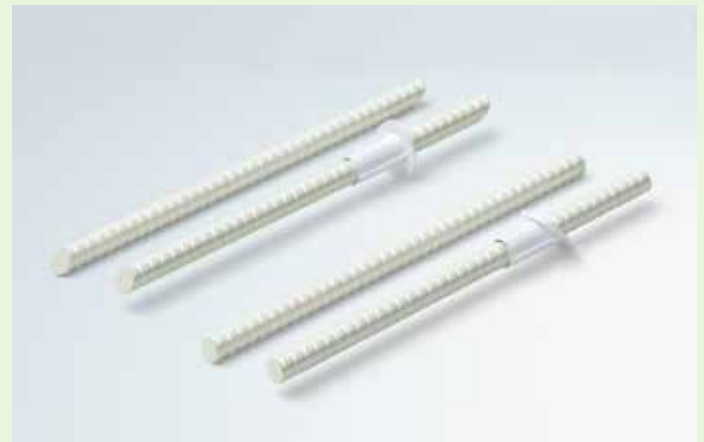
Die Fassadenbefestigung aus Glasfaserverbundwerkstoff Schöck Isolink® ist die energieeffiziente Alternative zu herkömmlichen Edstahllösungen bei der Verbindung der Betonschalen von kerngedämmten Sandwich- und Elementwänden. Foto: Schöck Bauteile GmbH
