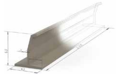
Einzelement einer ALE aus Textilbeton
