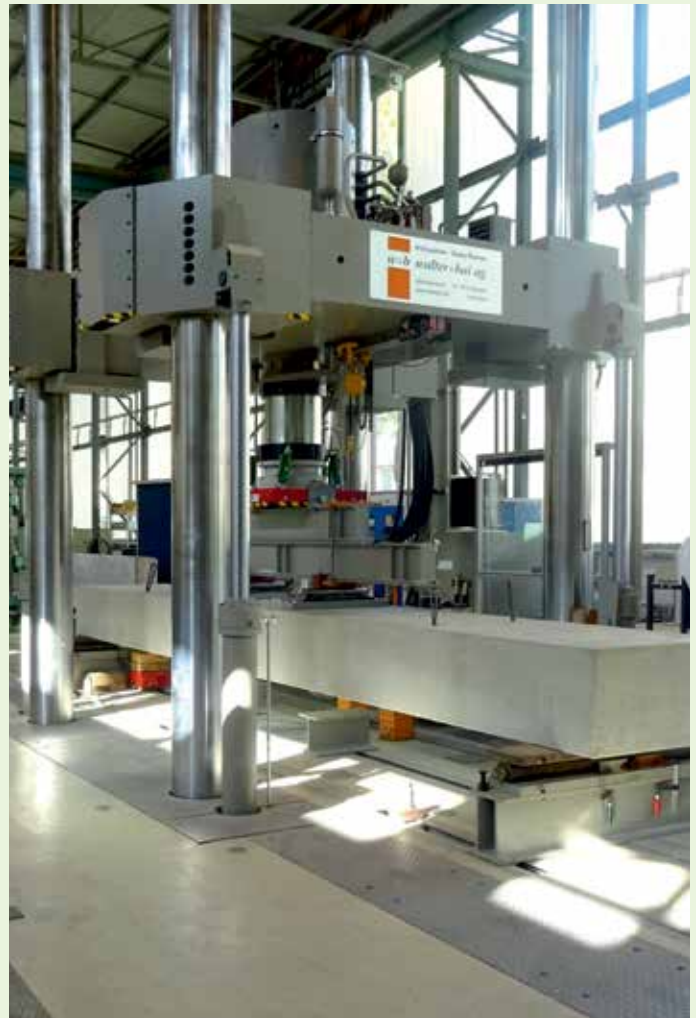
Experimentelle Prüfung eines Großbauteils (7 m weit spannendes Bauteil) im Rahmen eines ZiE-Prozesses Foto: CARBOCON GmbH
