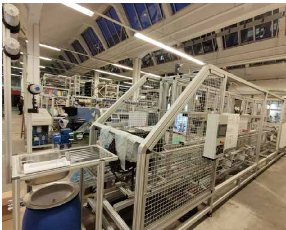
Laboranlage zur Herstellung von Carbongarnen mit tetraederförmiger Profilierung auf Grundlage tränkumformtechnischer Methoden
