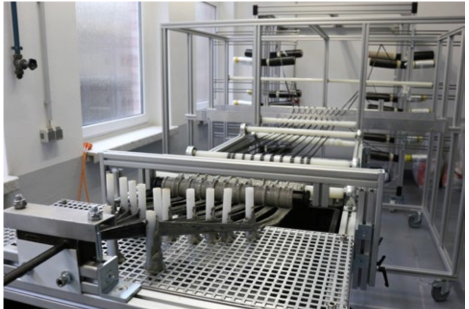
Zuführung und Tränkung der Carbonrovings (8mal 50k)
