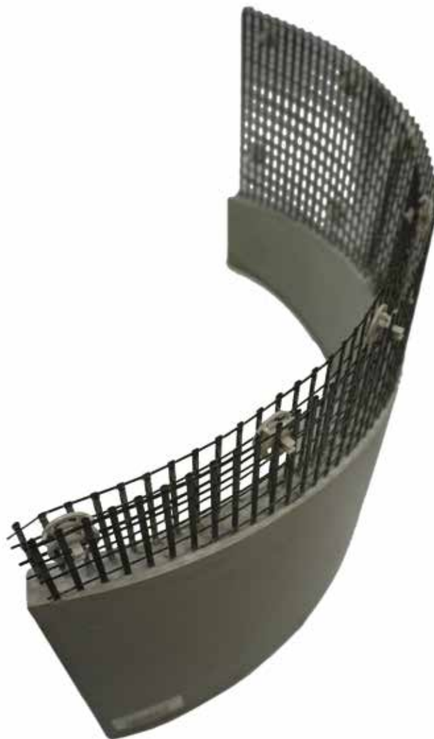
Bild 2.4: Beispiel einer zylindrisch gekrümmten Schale mit einem Abstandsgelege aus Carbonfasergarnen (Hersteller V. FRAAS Solutions in Textile GmbH) Foto: Ulrich van Stipriaan
